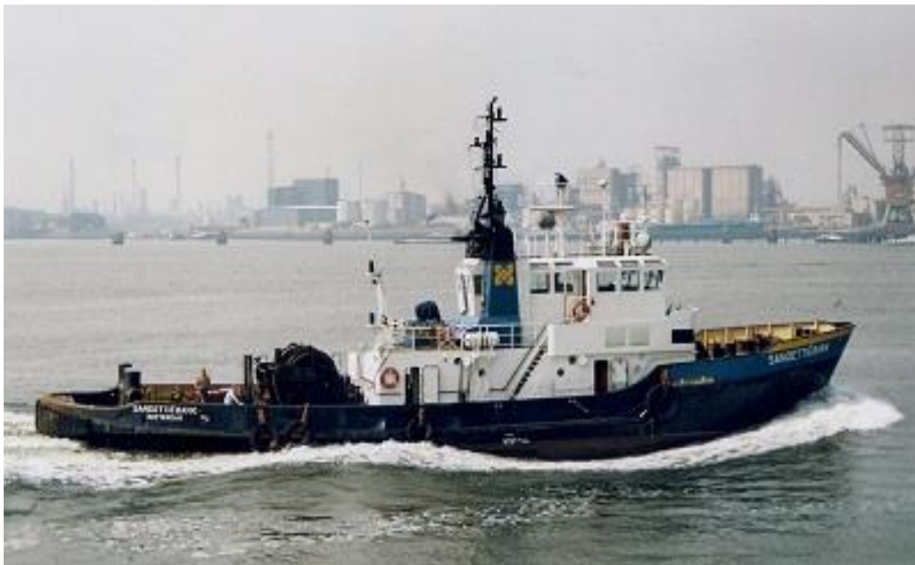
Sandtietbank a Rotterdam Voith Schneider tug 34.30 meters in length and 34 ton bp
